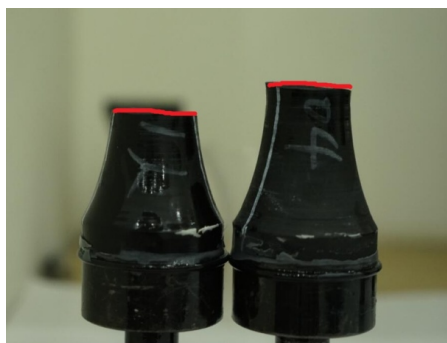
图 7 拉伸破坏 (围压 10 MPa)
