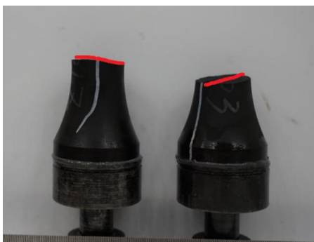
图 8 剪切或者拉伸-剪切复合破坏
